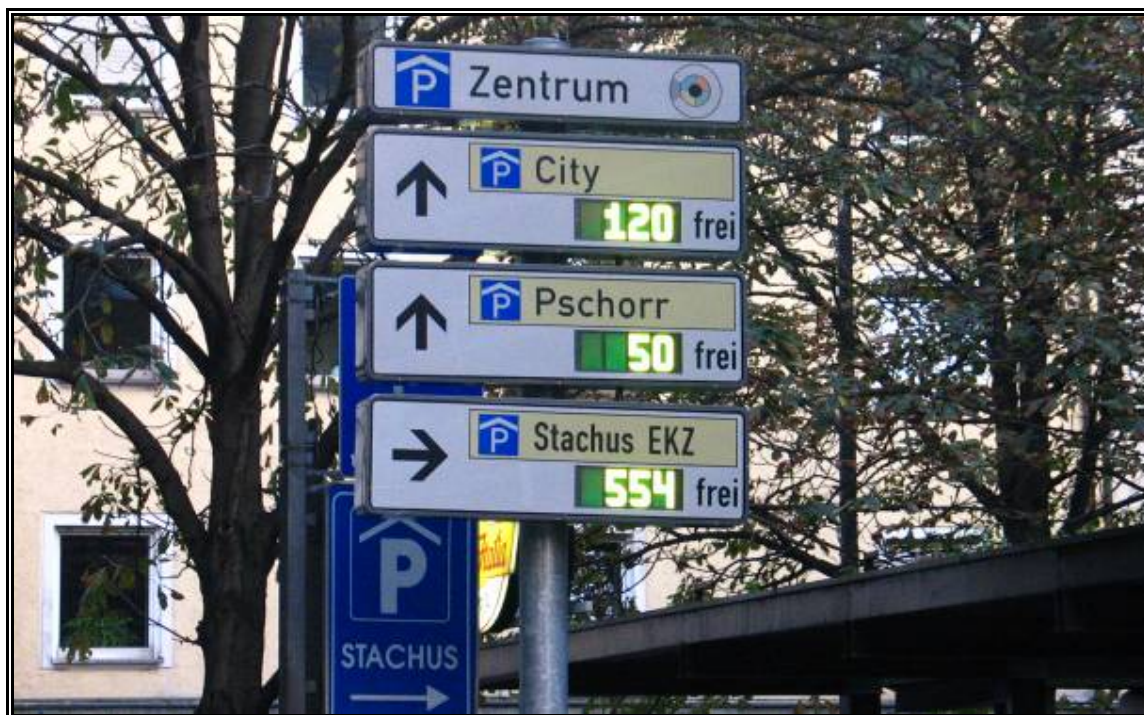
2. Integrált, intelligens parkolás-menedzsment Münchenben. Az elérési útvonalat és a szabad férőhelyek számát folyamatosan nyomon lehet követni (Fotó: Ekés András)
