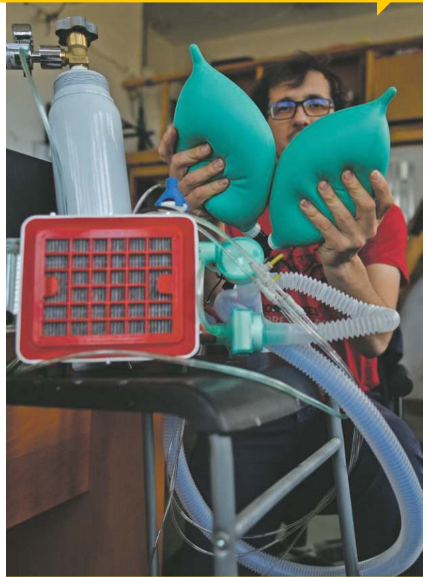
Szymon Chrupczalski lengyel fejlesztő bemutatja, hogyan segít a légszében a 3D nyomtató használatával olcsón előállítható lélegeztetőgép, melynek terveit ingyen elérhetővé is tették az interneten.
